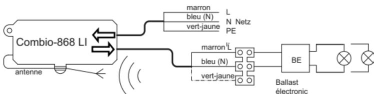
L'alimentation électrique du Combio-868 LI se fait via des bornes à ressort avec 230 V CA.
