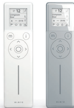
TempoSon-868 1 15-Kanal-Funkhandsender mit Display, NFC, Astro- und Slider-Funktion und Hand-/Automatik-Umschaltung in weiß und silber
